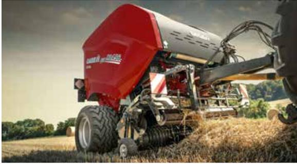
„Die neuen Modelle verfügen dazu über Walzen und Wellen, die wie auch die Heckklappe verstärkt und vergrößert wurden. Gleichzeitig wurden hier ein leistungsfähigeres Getriebe und ein stärkerer Antriebsstrang verbaut; beides ermöglicht eine höhere Anzahl von Ballen pro Stunde. Um die Zuverlässigkeit und den Zugang für Wartungsarbeiten zu optimieren, wurde u. a. die Anzahl der Antriebsketten und Schlittenwalzen reduziert.“
