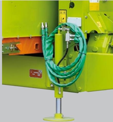
Hydraulischer Stützfuß mit direkten Traktoranschluß
