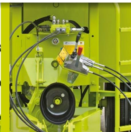
Zweistufiges Schaltgetriebe auch mit Bowdenzugbedienung erhältlich (Zubehör)
